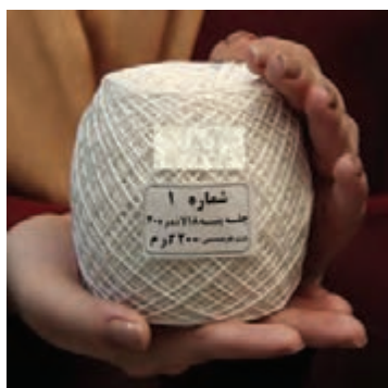
شکل ۱۸-۲- توپک ۲۰ گرمی، چله پنبه ای ۱۸ لا نمرة ۲۰
