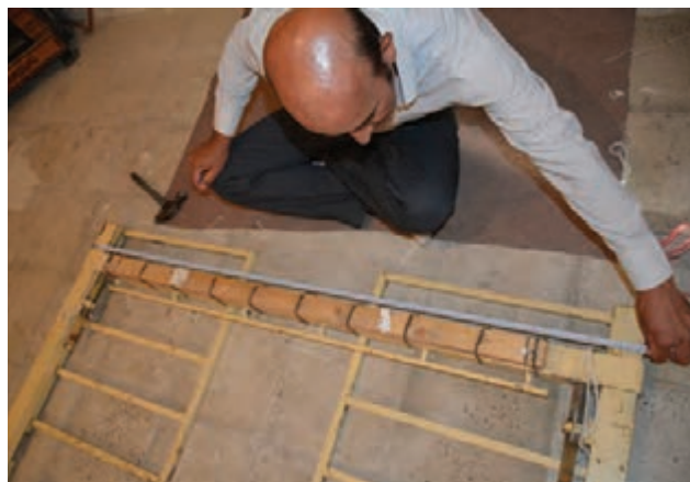
شکل ۱۶-۵ - نصب چوب پایین کشی پشت زيردار
