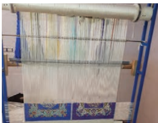
شکل ۳۶- ۵- پیچیدن مقدار لازم برای پایین کشی به دور زیر دار
