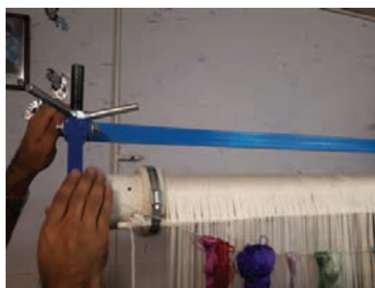
شکل ۳۵- ۵- شل کردن دار
