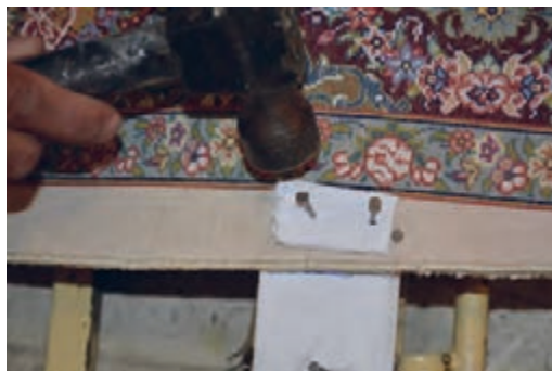
شکل ۲۴-۵ - ثابت کردن فرش با میخ
