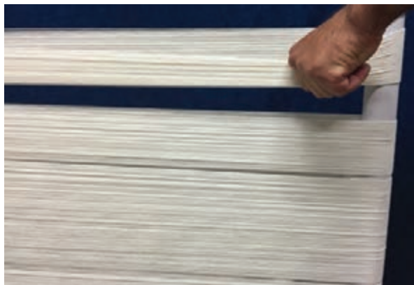
شکل ۳۰-۲- تنظیم تارها بر روی میله
