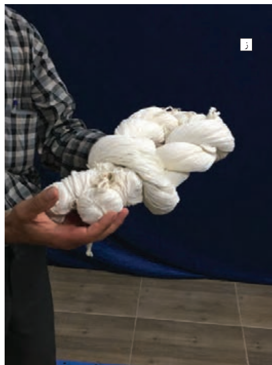
شکل ۳۹-۲- مراحل بیرون آوردن چله از دستگاه
