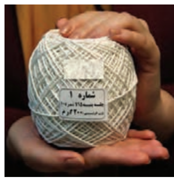
شکل ۱۷-۲- توپک ۲۰ گرمی، چله پنبه ای ۱۵ لا نمرة ۱۰
