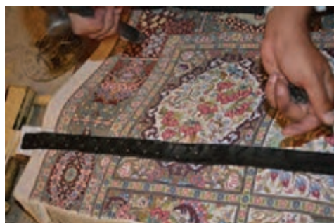
شکل ۲۸-۵ - ثابت کردن ابتدای لاستیک پایین کشی با میخ
