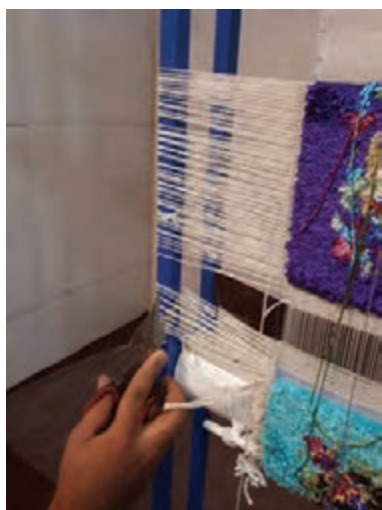
شکل ۳۴- ۵- بریدن انتهای پودها قبل از پایین کشی
