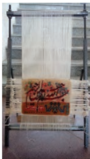
شکل ۱۵-۴- پیچیدن پودها به دور راست روها
