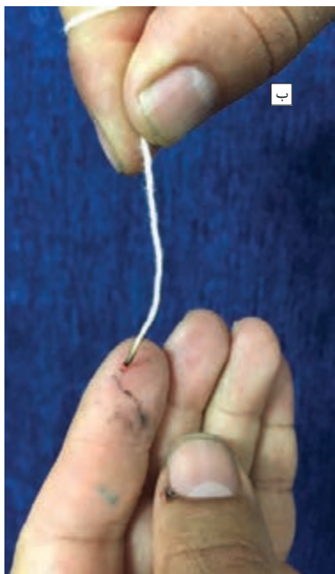
شکل ۱۱-۲- نخ چله پنبه‌ای در حالت سوزاندن
