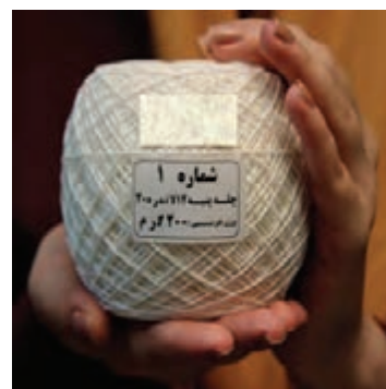
شکل ۱۶-۲- توپک ۲۰ گرمی، چله پنبه ای ۱۲ لا نمرة ۲۰
