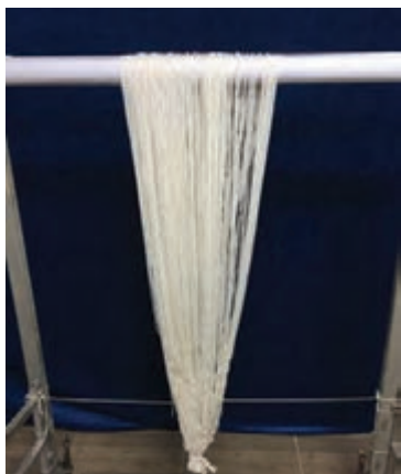
شکل ۳-۵- انتقال سردار بر روی دار بدون فندک
