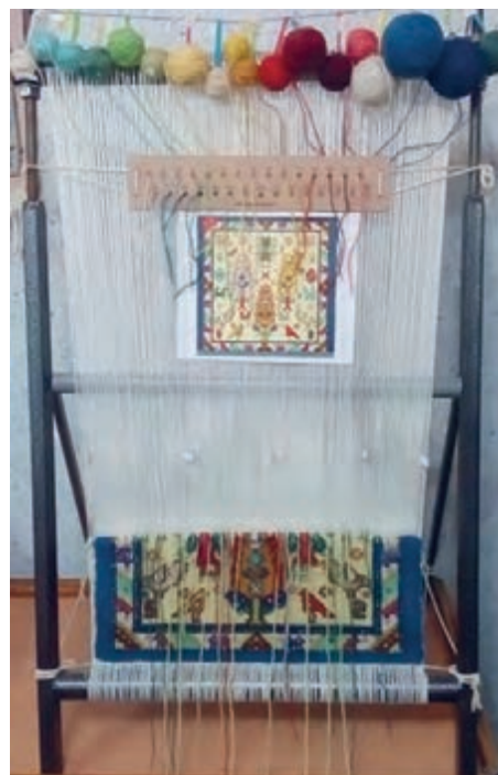
شکل ۹-۱- زیر دار ثابت و سردار متحرک (مدل ۱)
