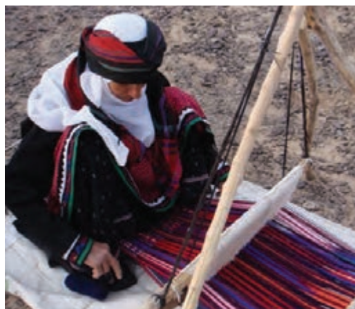
شکل ۱۹-۳- چله‌ریزی بر روی دستگاه برای بافت جاجیم
