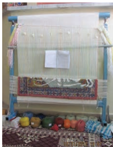
شکل ۱۰-۱- زیر دار ثابت و سردار متحرک (مدل ۲)
