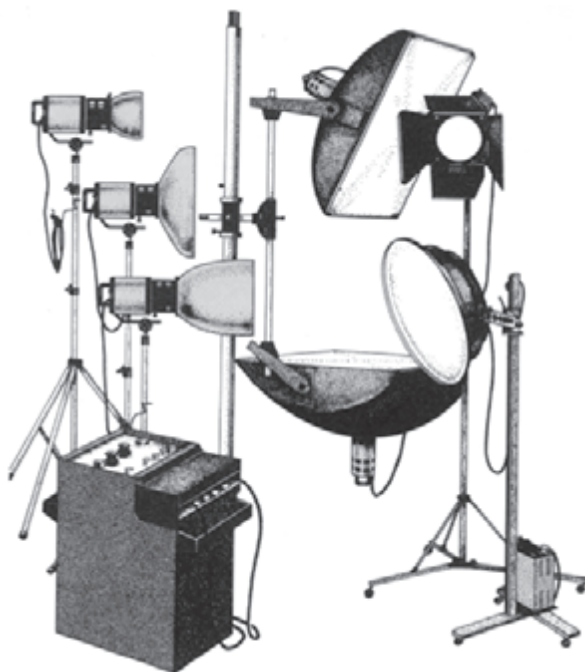
شکل ۴-۳- انواع نورافکن‌های تنگستن و فلاش‌های استودیویی
