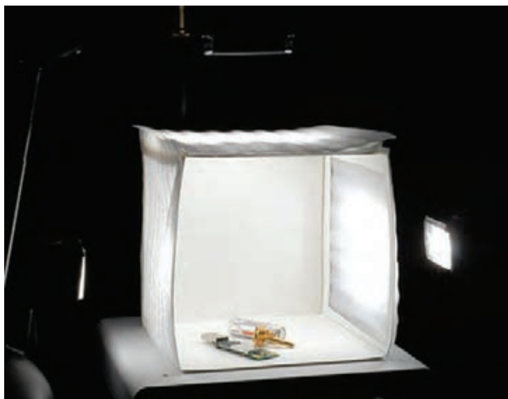
شکل ۳-۲۹- چادر نور برای از بین بردن بازتاب اشیاء و تصاویر اشیاء بر روی اجسام براق و فلزی به‌هنگام عکس‌برداری
